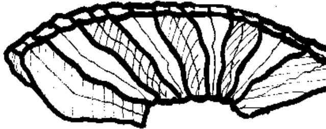
38. ábra: a kupola helyes kiterítése
