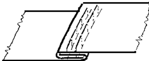
5. ábra: a kupola varrasi módja.
